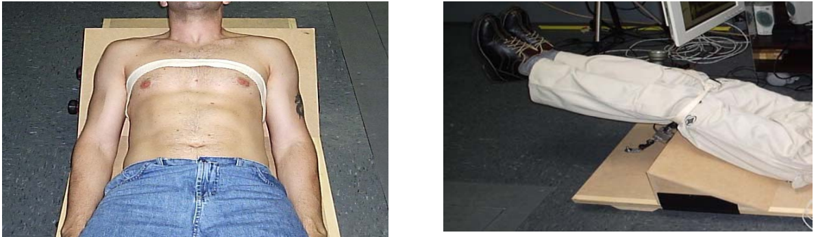
FIGURA 31 - Fixação da célula de carga ao tronco (esquerda) ou membros inferiores (direita).
